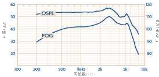
カスタムイヤ: カスタムイヤ最大マトリクス 117/50/10におけるOSPL90と最大音響利得
